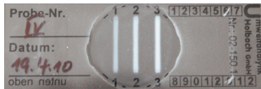
Bild 38 Total überladene Partikelpuren (nicht auswertbar)
