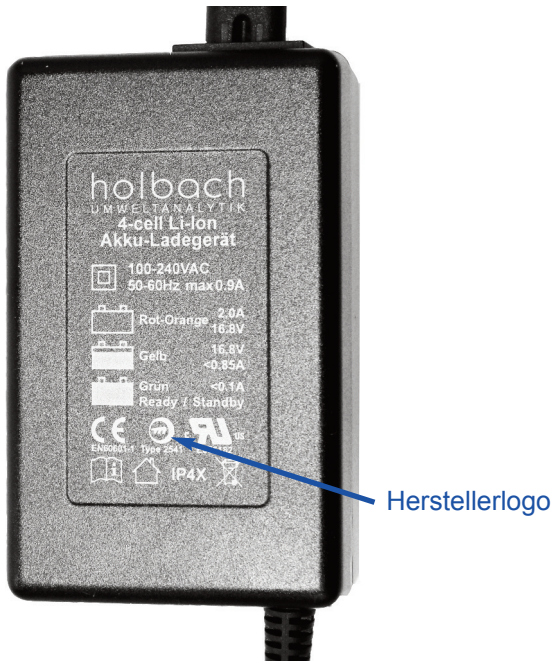
Bild 9 Die Rückseite des Ladegerätes mit Angabe der Statusfarben, Prüfzeichen und dem Herstellerlogo
