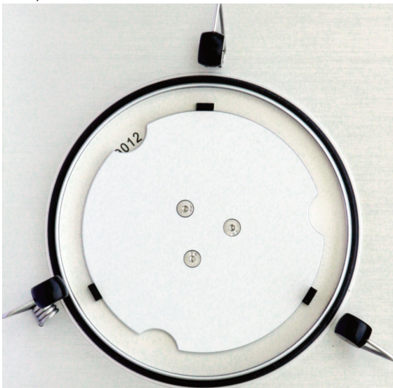
Bild 7 Medienzentrierung nach innen, Einstellscheibe auf 12
