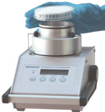
Bild39 Aufsetzen eines Gelatinefilters in einer Einwegeinheit
