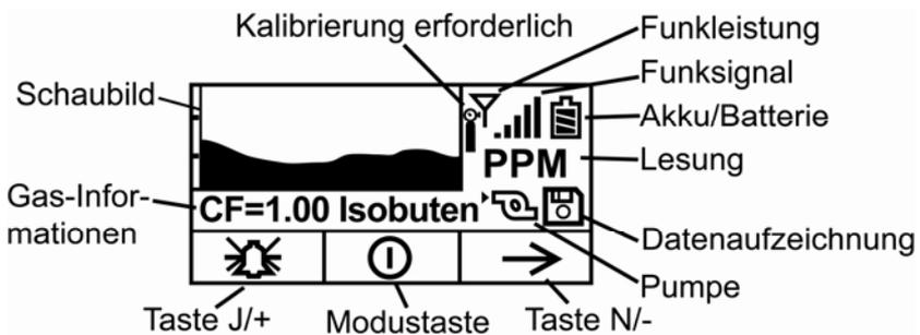
Während der Messung werden die ermittelten Werte numerisch angezeigt. Außerdem stellt die Grafik die höchsten Werte im Messungsverlauf dar. Die numerische Anzeige wechselt außerdem zwischen dem Wert und der Maßeinheit:
