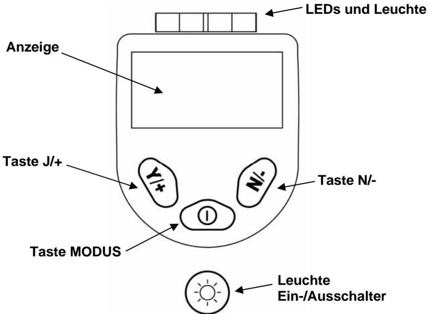
Neben den bezeichneten Funktionen dienen die Tasten J/+, MODUS und N/- als „Softkeys“, die verschiedene Parameter steuern und die Auswahl von Optionen in den Menüs des Geräts ermöglichen. Je nach Menü steuern diese Tasten verschiedene Parameter oder ermöglichen die Auswahl unterschiedlicher Optionen.
